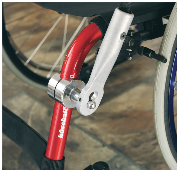
Bevestiging aan de voorkant: rolgordel onder handvat van de rolstoel
