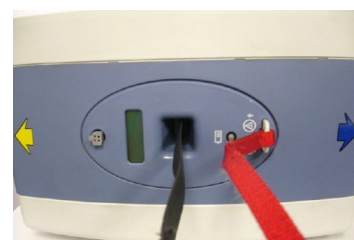
Figuur 6C: De gekleurde knoppen op de handbediening komen overeen met de gekleurde pijlen op de onderkant van de lift.
