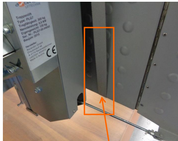
spanband onder tussen platform en draadstang doorsteken
