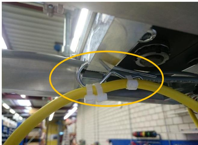
4. Nun wird das Netzgerät am passenden Ort montiert und die Kabel an die Kabelrolle angeschlossen.
