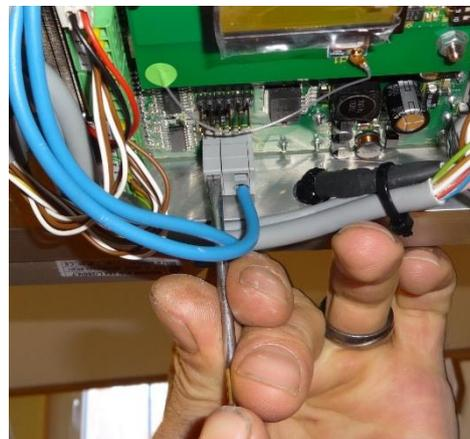
2. Beide Stromabnehmer und Endhaltüberwachung montieren.
