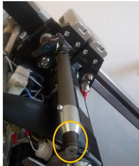
12. Nun kann das Kupfer mittels der Kupferführung und dem Fahrwerk über die ganze Schiene eingepresst werden. **Niemals mit der montierten Kupferführung rückwärtsfahren, da sonst der Kupfer geknickt wird.**
